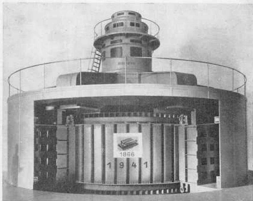
*Modell eines 100 000-Kilowatt-Wasserkraftgenerators für Mandschukuo. Im gleichen Maßstab eingezeichnet die erste Dynamomaschine von 1866*
